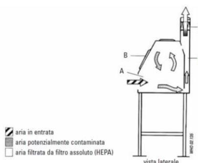
Le cappe di Classe I sono ampiamente utilizzate. Hanno il vantaggio di proteggere gli operatori e l'ambiente e possono essere anche utilizzate per lavori con radionuclidi e prodotti chimici volatili tossici. Poiché l'aria che penetra sul piano di lavoro attraverso l'apertura frontale non è sterile, questo tipo di cappa non è idoneo per proteggere il prodotto da eventuali contaminazioni.
